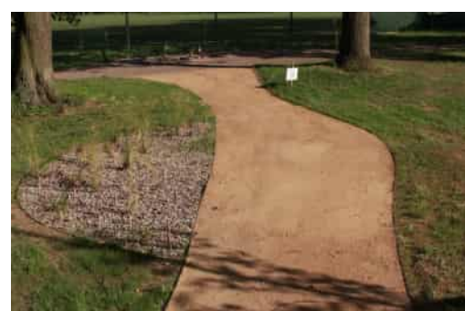
Parkové cesty budou řešeny mlatovým povrchem se zapuštěnými ocelovými obrubami.
